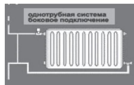
Установка байпасса позволяет Вам менять радиаторы даже в ходе отопительного сезона, ремонтировать радиаторы, а также регулировать тепловую мощность отдельных радиаторов без нарушения циркуляции в стояке отопления.
